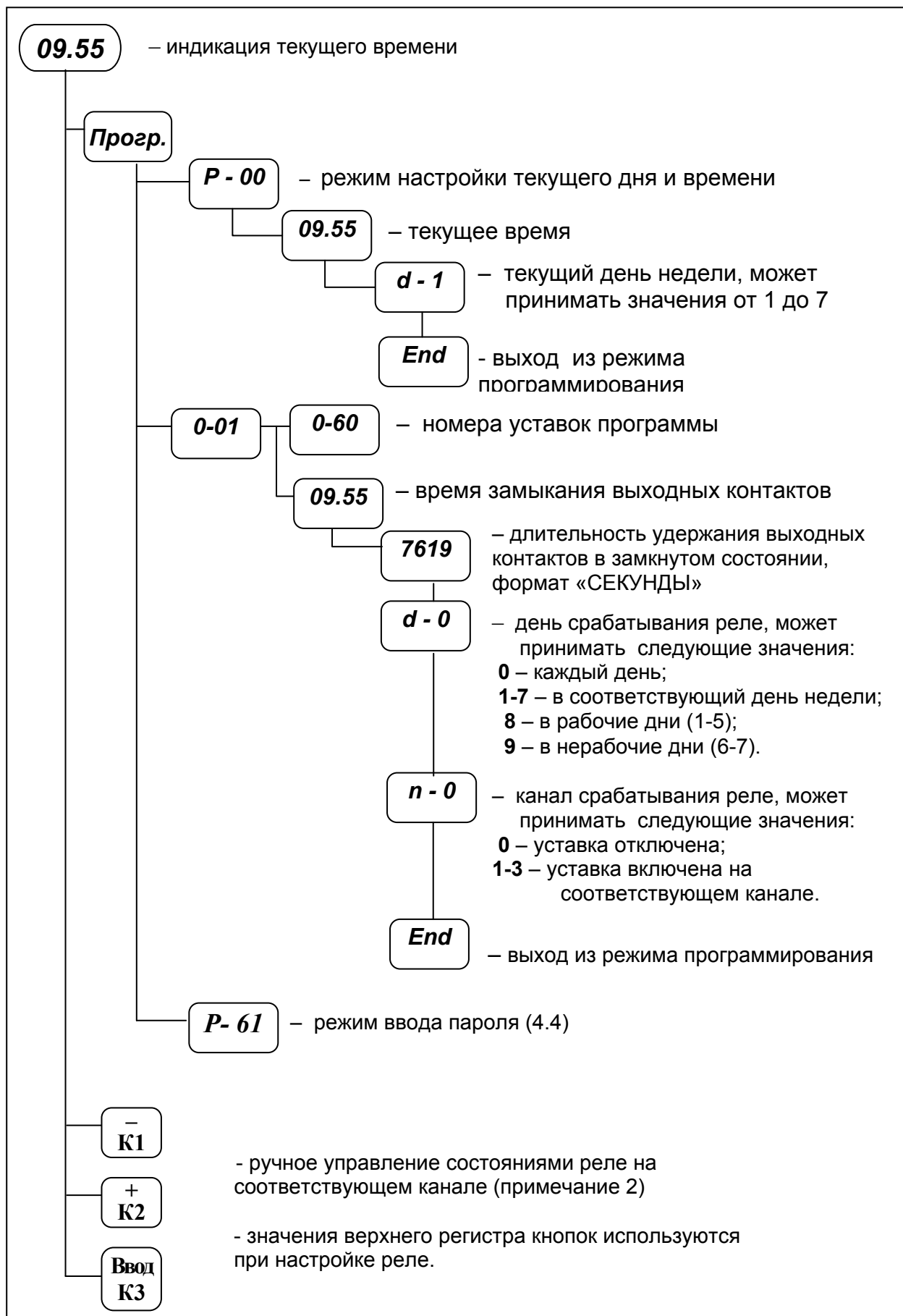
Рисунок 6 - Порядок настройки уставок реле РВЦ-03-12, РВЦ-03-14
